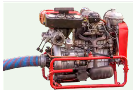
Z výzbroje naší jednotky: Motorová požární stříkačka PS 12
